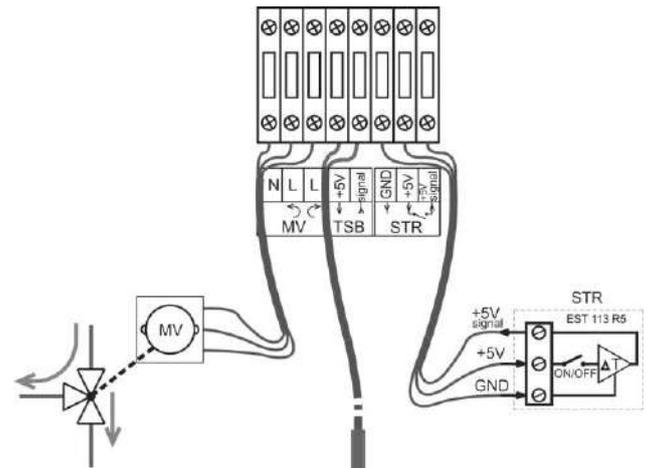
Kambario termostato, zondo temperatūros matavimui katile ir variklio trijų kryptčių vožtuvui (230V 50Hz) prijungimo schema.
